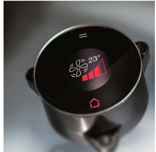
CDS1 – konfigurerbar kontakt med OLED-skærm og PCAP touch.
